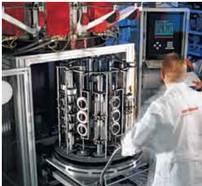
Vor der Beschichtung werden die Teile auf auswechselbaren Substrat-halterungen chargiert und in die Anlage eingefahren.
